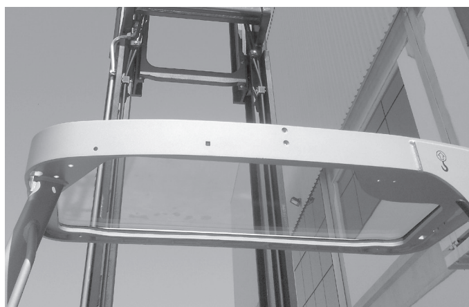
Opção de teto de vidro blindado com excelente visibilidade dos garfos e da carga
